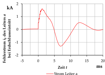
Abb: Leiter-Erde-Spannungen und Fehlerstrom bei Erdschluss im 110-kV-Netz
